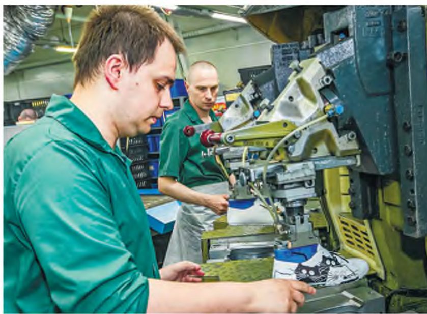
Для скрепления подошвы с верхом обуви используют в основном два метода. Один из них – литьевой.
